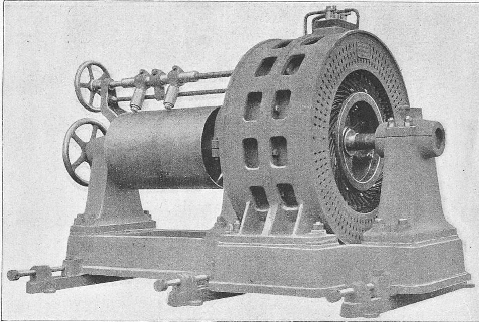
Generatoren nicht nur durch ihre Umspinnung und die gewöhnlichen isolierenden Unterlagen geschützt, sondern der ganze Eisenkranz der Armaturen ist nochmals durch eine isolierende Schicht vom Gestell getrennt. Die Transformatoren in den Sekundärstationen sind alle auf Porzellanfüsse gestellt. Alle Messinstrumente und Apparate für Hochspannung sind auf Marmor montiert und von diesem durch
