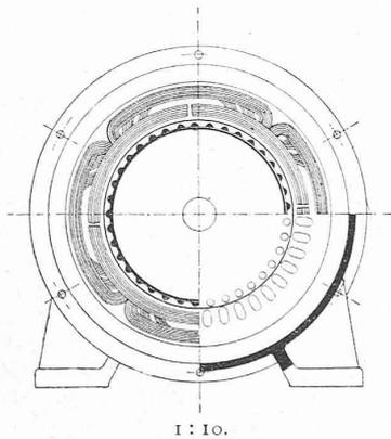
Fig. 16. Einphasen-Wechselstrom-Motor. Längenschnitt.
