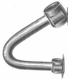
**Pleuelstange**, 45 mm dick, hohl gegossen, blank gedreht, nachher unter dem Hammer kalt zusammengeslagen, ohne irgend welche Risse oder Bruchstellen, auch mit der Loupe betrachtet, zu zeigen.
