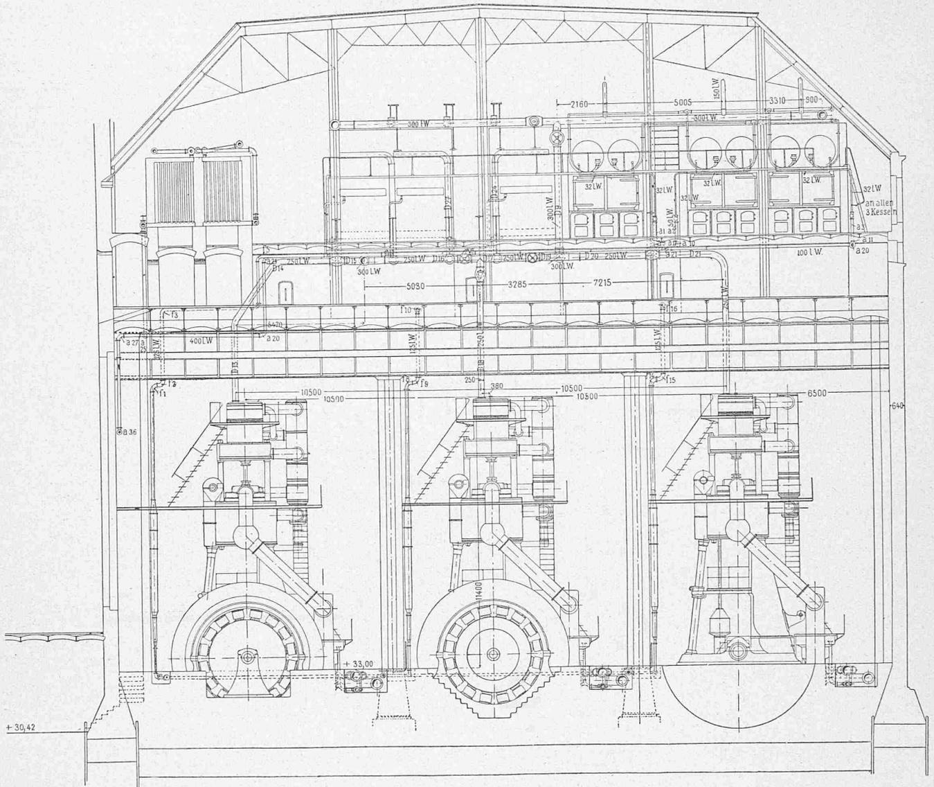
Fig. 6. Schnitt durch Maschinen- und Kesselraum. — Masstab 1 : 200.
