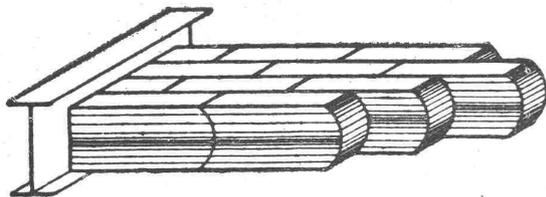
Dieses neue, geradlinige, massive Deckensystem zeichnet sich durch **grösste Einfachheit** aus. Es ist nur ein **Formstein** notwendig, kann von jedem tüchtigen Maurer **ohne Schalung** mit Kalkmörtel ausgeführt werden. **Beliebige Trägerdistanzen** von 0,5—2,5 m. Grosse Nutzlast und **Eisensparnis**.
