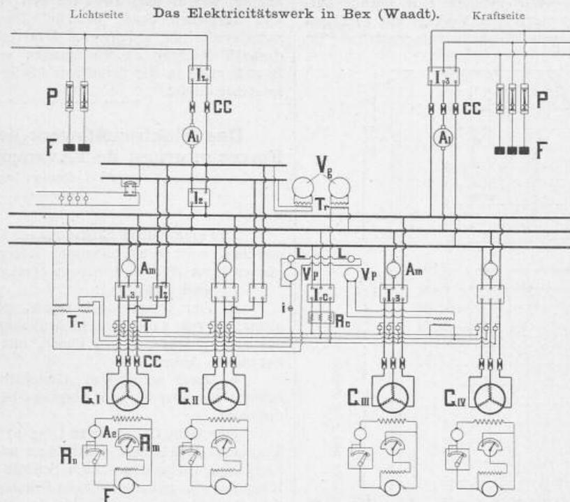
Fig. 18. Schaltungsschema der Drehstromanlage für die Kraft- und Lichtleitung.
