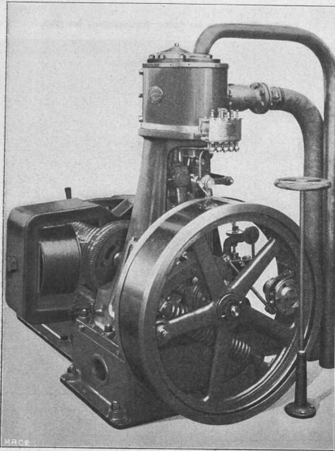
Fig. 9. Vertikale Kolbenschieber-Maschine von *Gebr. Sulzer* in Winterthur.
