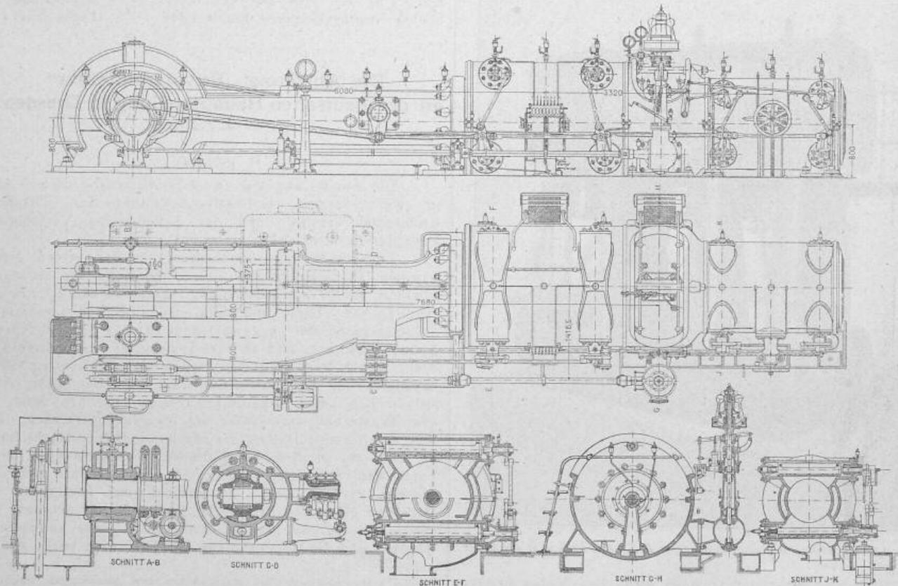
Fig. 11. 1000-pferdige Tandem-Verbundmaschine von *Escher Wyss & Cie.* in Zürich. — Aufriß, Grundriß, Schnitte. 1:70.
