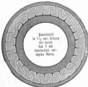
Querschnitt in 1/2 nat. Grösse der durch das Y bei Amsterdam verlegten Rohre.
