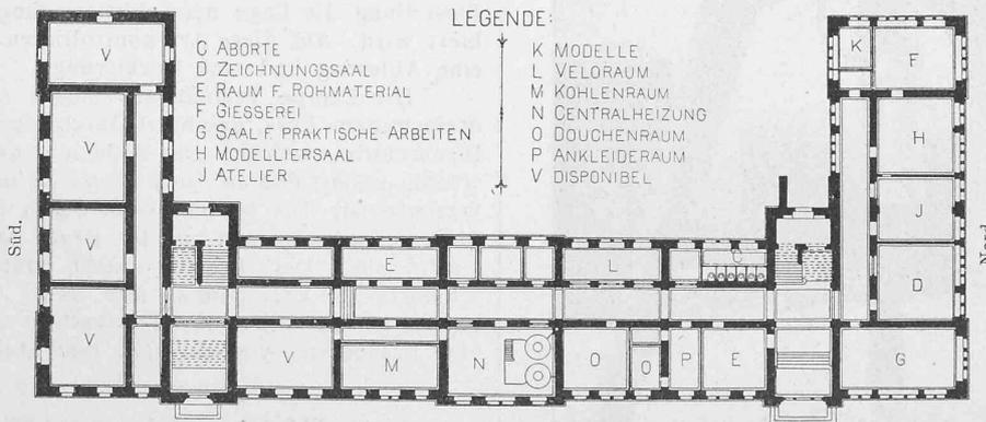
Grundriss vom Untergeschoss. — Masstab 1 : 750.
