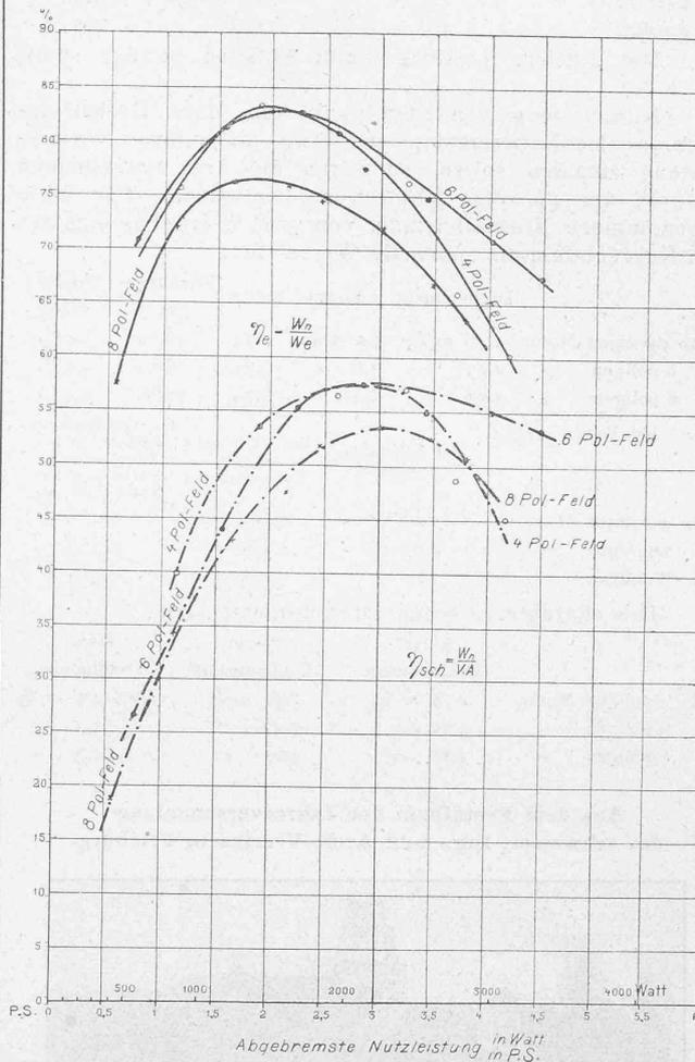
Abb. 4. Kurven des Wirkungsgrades der drei Einzelmotoren.
