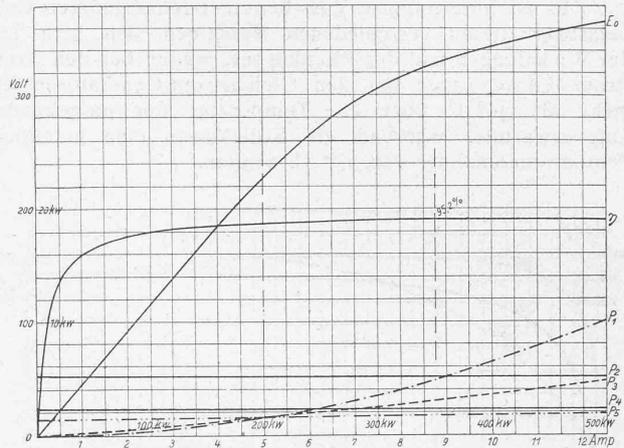
Abb. 2. Gleichstrom-Generator von 350 kw. Typ. N. N. XV. 260 Volt, 1350 Amp., 375 Umdr.
