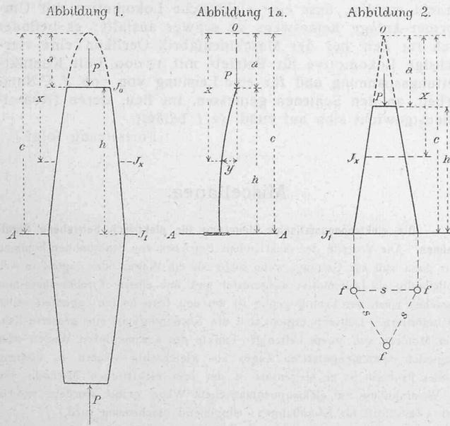
Für die entgegengesetzte Grenze, bei welcher das Paraboloid, wenn das Trägheitsmoment  $J_0$  der Kopffläche sich dem Werte des Trägheitsmomentes  $J_1$  der Grundfläche nähert, sich der Cylinderform anschmiegt, folgt für  $a = c = b$
