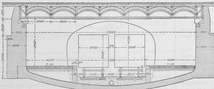
Abb. 12. Typischer Querschnitt einer überdeckten Station. — Masstab 1 : 150.
