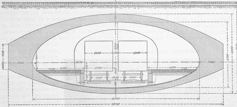
Abb. 11. Typischer Querschnitt einer gewölbten Station. — Masstab 1 : 150.
