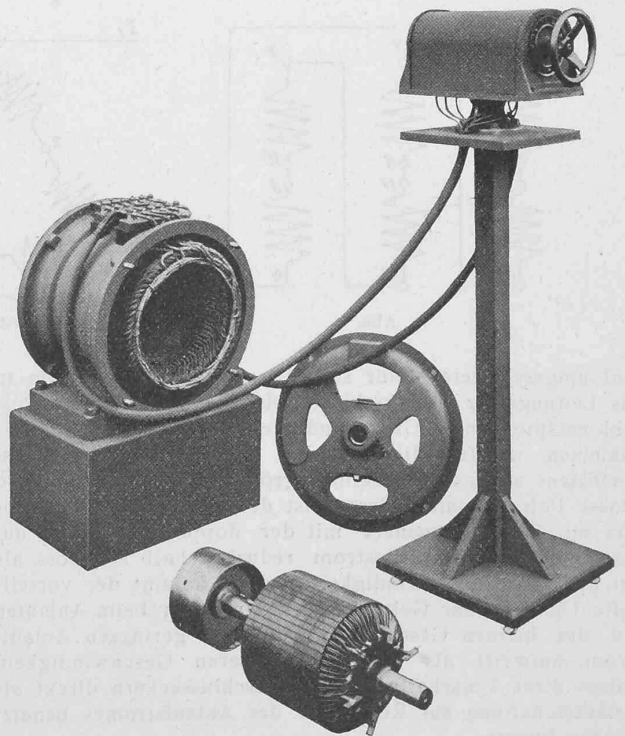
Abb. 9. Vierstufen-A-Motor, System Oerlikon. — Demontiert. Umdrehungszahl: 500, 750, 1000 und 1500. Leistung: 4—6 P. S.
