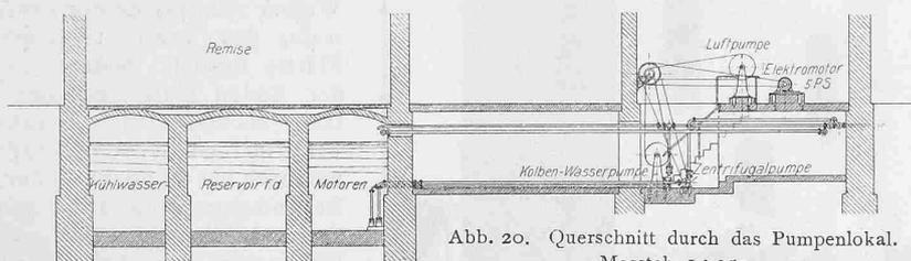
Abb. 20. Querschnitt durch das Pumpenlokal. Masstab 1:250.
