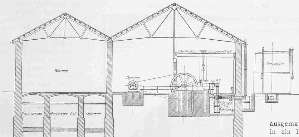
Abb. 19. Die Kraftzentrale. — Querschnitt durch Remise und Maschinensaal. — 1:250.
