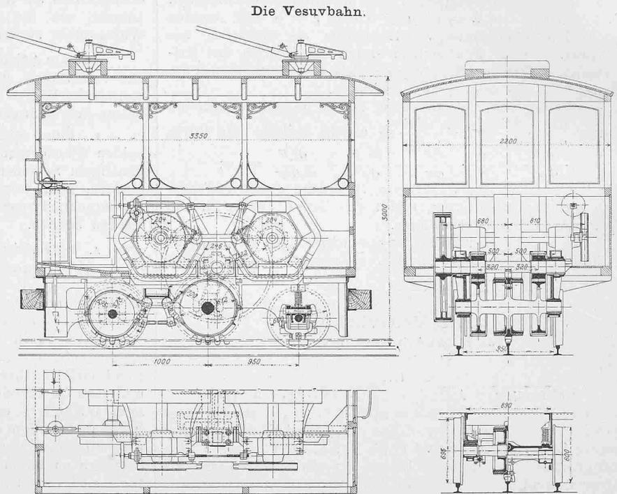
Abb. 15. Elektrisch angetriebene Zahnradlokomotive. — Masstab 1 : 50.
