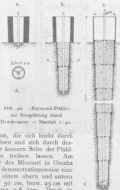
Abb. 40. «Raymond-Pfähle» zur Einspülung durch Druckwasser. — Masstab 1:40.
