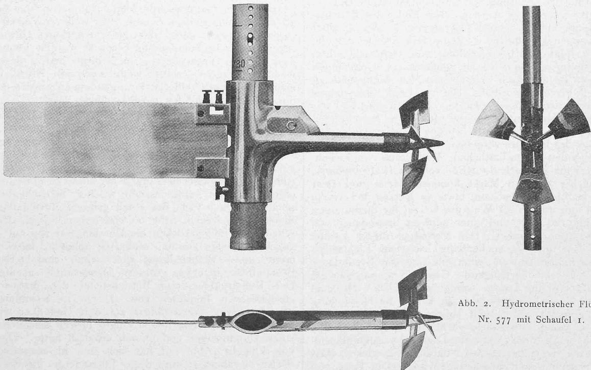
Abb. 2. Hydrometrischer Flügel Nr. 577 mit Schaufel 1.
