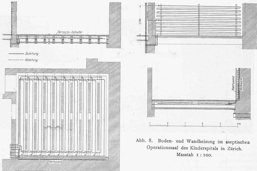
Abb. 8. Boden- und Wandheizung im aseptischen Operationssaal des Kinderspitals in Zürich. Masstab 1 : 100.
