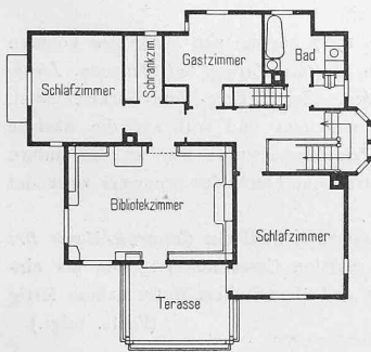
Abb. 8. Grundriss vom Obergeschoss des Hauses Hesse. — 1:400.
