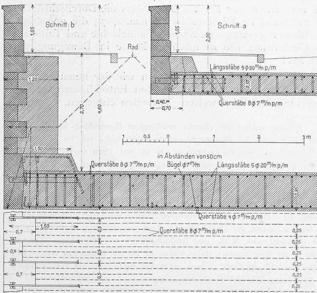
Abb. 27. Querschnitte a und b und Armierungsplan. — 1 : 75.
