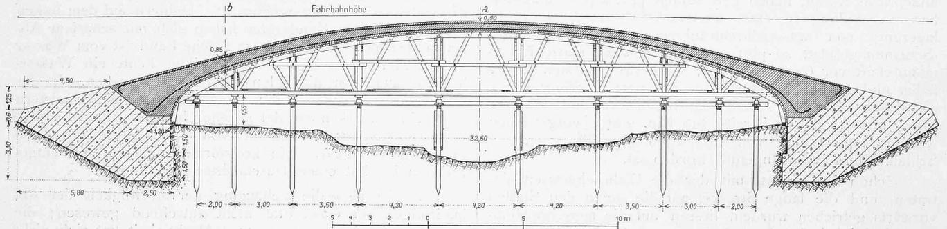
Abb. 26. Längsschnitt durch die Galfingerbrücke mit Lehrgerüst. — Masstab 1 : 250.
