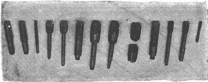
Gruppe von Werkzeugen zur Herstellung genauer und billiger Bohrungen nach Chucking-Methode.
