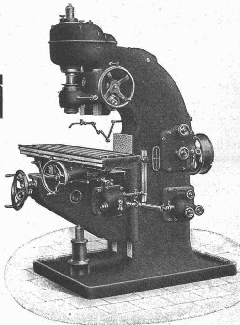
Vertikal-Fräsmaschine Nr. 3.
