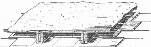
**Armierter Betonhohldecke** mit ebener Untenseite und Plafond
