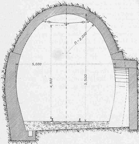
Abb. 4. Fahrdrabt-Aufhängung im Tunnel.
