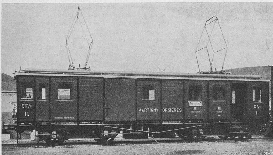
Abb. 14. Güter-Motorwagen, gebaut von der Schweiz. Waggonfabrik Schlieren.
