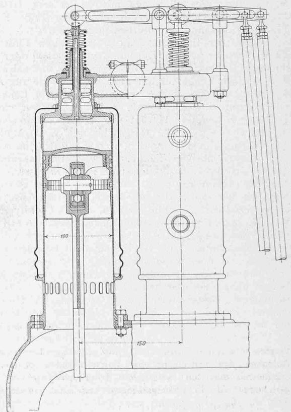
Abb. 4. Horizontalschnitt in Zylinderaxe. — Masstab 1:5.
