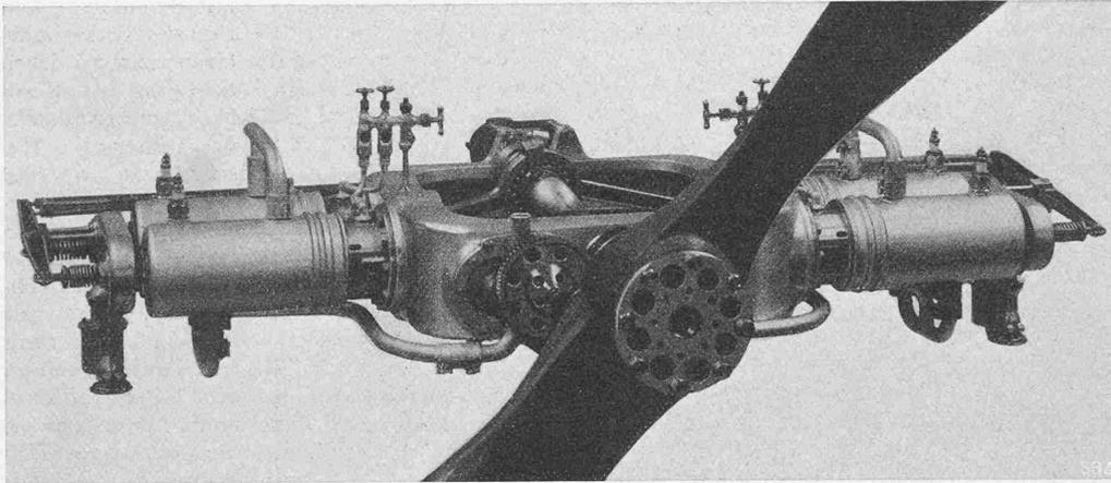
Abb. 1. Vorderansicht des Flugmotors „Oerlikon“ mit Propeller.
