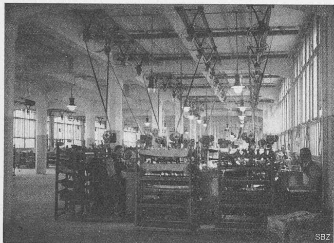
Abb. 21. Arbeitsaal mit Pressgas-Beleuchtung im III. Stock.
