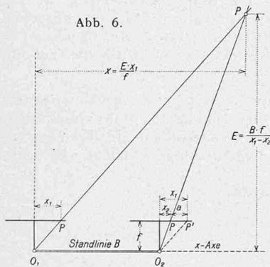
Betrachtet man bei nach den Grundsätzen der Stereophotogrammetrie aufgenommenen Bildern einen Bildpunkt, dessen Projektion im linken Bild mit dem Bildhauptpunkt zusammenfällt, und dessen Projektion im rechten Bilde im Abstände  $a$  vom Hauptpunkt erscheint, so berechnet sich die Entfernung des Punktes von der Standlinie aus
