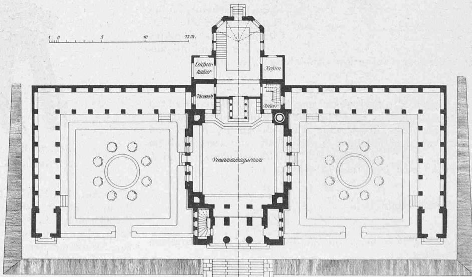
Grundriss des Krematoriums mit Urnenhallen. — Masstab 1 : 400.
