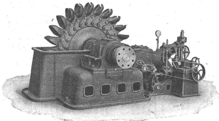
Turbine Pelton de 6300 HP, avec régulateur à double action.
