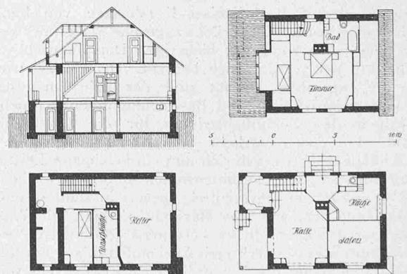
Abb. 1. Landhaus Debeuf. — Grundrisse und Schnitt 1 : 400.
