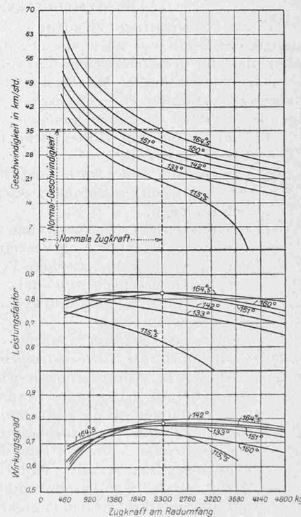
Abb. 4. Charakteristische Kurven eines Einphasen-Bahnmotors mit Deri-Schaltung der A.-G. Brown, Boveri & Cie. für 3000 PS, 1000 Volt, 16 2/3 Perioden bei verschiedenen Bürstenstellungen.
