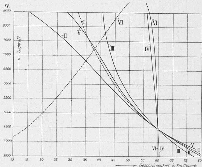
Abb. 1. Zugkraft-Geschwindigkeits-Charakteristiken verschiedener Bahnmotoren ohne Regulierung.
