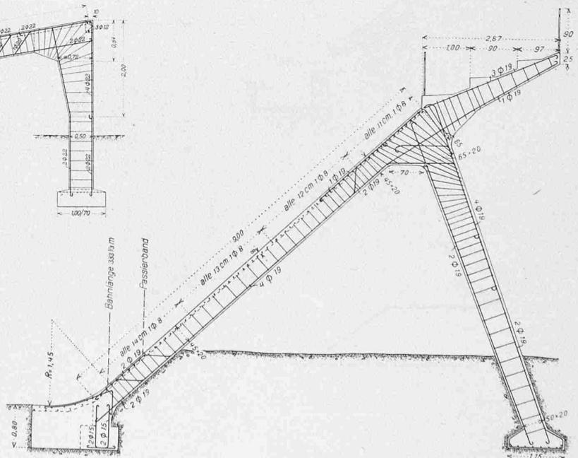
Abb. 10. Binderkonstruktion in den Steilkurven. — 1 : 100.
