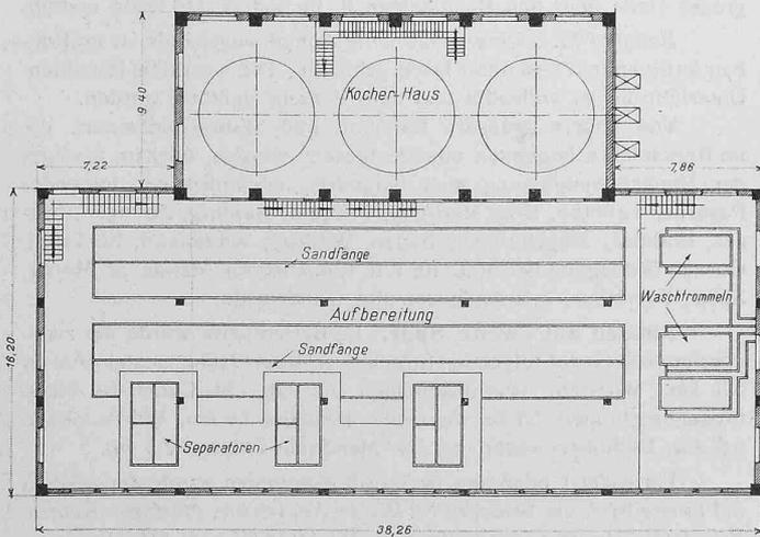
Abb. 2. Kocherhaus-Querschnitt und Grundriss. — 1:400.
