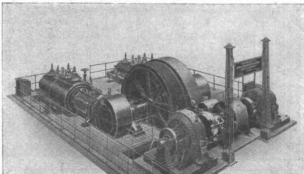
Zur Uebertragung von 800 PS werden von dem 24-rilligen Schwungrad unter Anwendung einer von uns gelieferten Bandage nur 805 mm benötigt.
