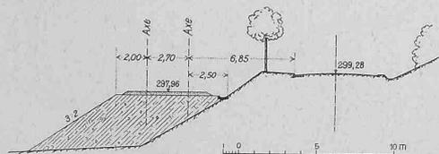
Abb. 13. Profil der Strassenbahn an der Jakobbergerstrasse. Masstab 1 : 400.
