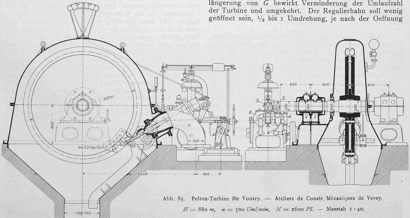
Abb. 85. Pelton-Turbine für Vouvy. — Ateliers de Constr. Mécaniques de Vevey.
