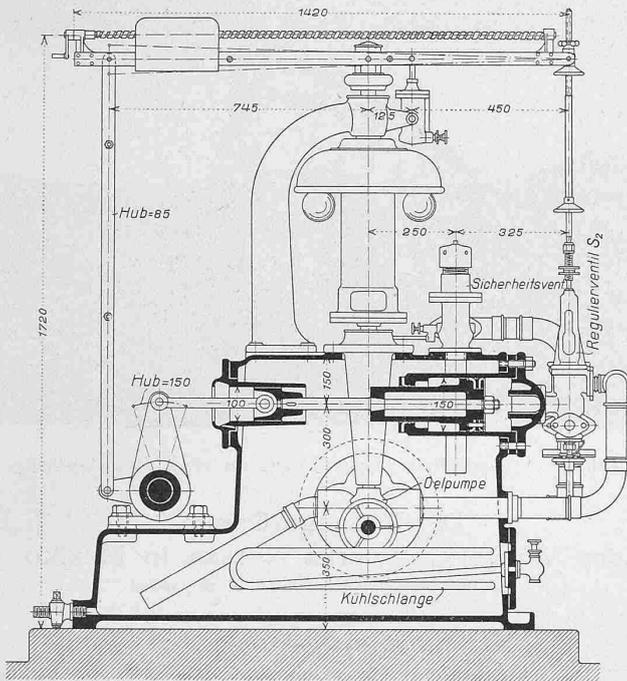
Abb. 86. Regulator und Servomotor-Längsschnitt. — 1 : 20.
