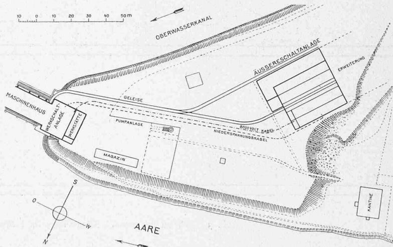
Abb. 1. Uebersichtsplan der Schaltanlagen des E.-W. Beznau.
