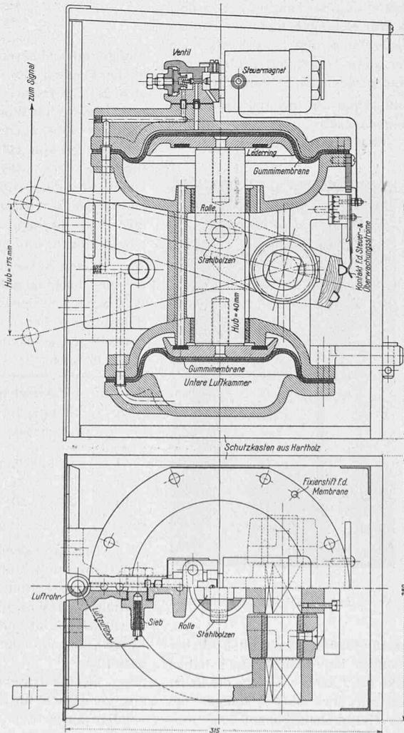
Abb. 5. Kolbenloser Druckluft-Signalantrieb. Querschnitt und Grundriss. — Masstab 1 : 50.
