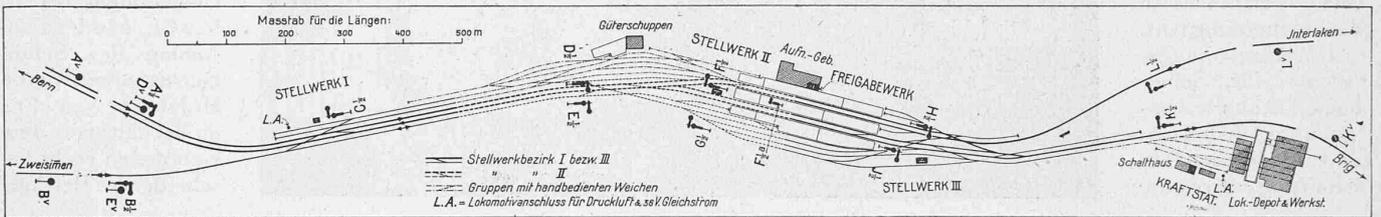
Abb. 1. Schematischer Lageplan des Bahnhofes Spiez der Lötschbergbahn.
