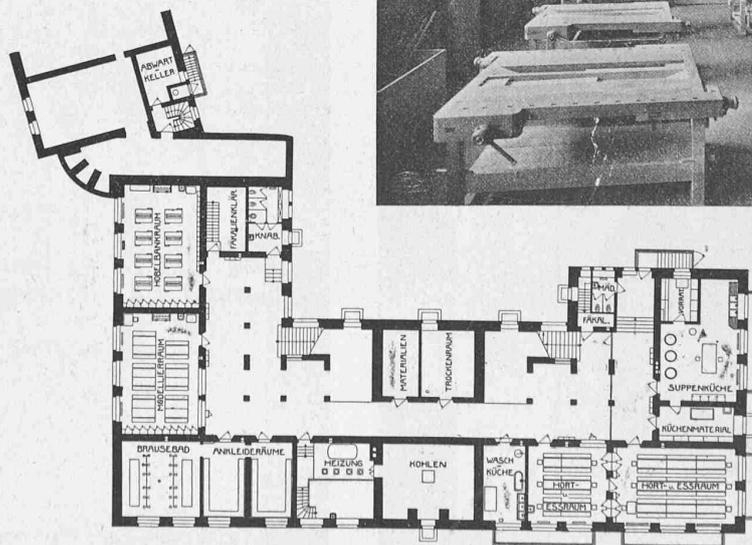
Abb. 13. Untergeschoss des Schulhauses. — Masstab 1:600.
