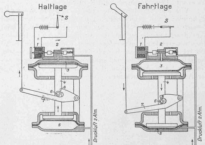
Abb. 4. Schema des kolbenlosen Druckluft-Signalantriebs.
