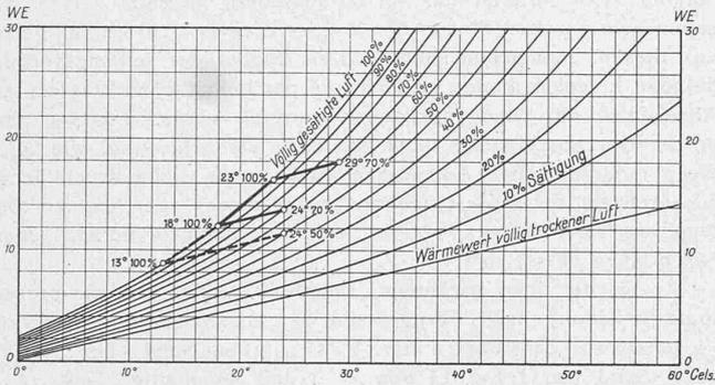
Wäre z. B. die Temperatur des Raumes (trockenes Thermometer) 20° C und die relative Luftfeuchtigkeit 20%, und geht man im Diagramm von dem Punkte, der diesen Zustand darstellt, auf einer Parallelen zur Abszissenaxe (Linie konstanten Wärmehaltes) nach links, bis zur Kurve für vollgesättigte Luft, so schneidet man diese Kurve bei einer Temperatur von 9° C. Bis zu dieser Grenze wird sich das feuchte Thermometer abkühlen.
