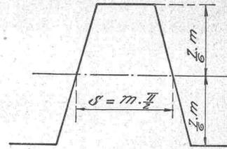
Fig. 4. Normales Zahnstangenprofil.
