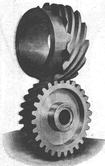
Figur 5. Steuerräder für Rohölmotor.
