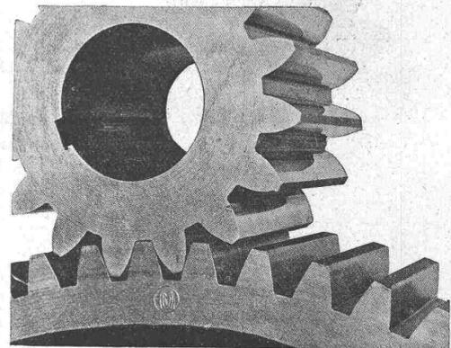
Figur 4. Mit gehärtetem und geschliffenem Maag-Ritzel.
