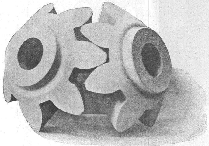
Figur 2. Kegelaradgetriebe 7/7.
