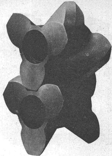
Schraubenrädergetriebe 3/3. Gehobelte Maag-Verzahnung.
