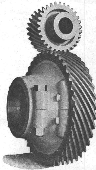
Figur 6. Steuerräder für grossen Dieselmotor.
