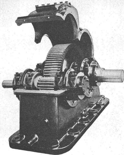
Figur 1. Turboreduktionsgetriebe mit gehärteten und geschliffenen Stirnrädern 6000/1000. 300 PS.
