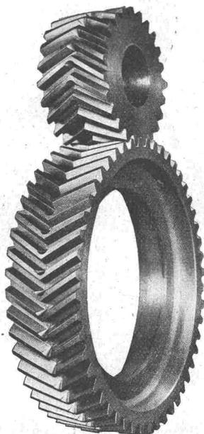
Figur 5. Pfeilradgetriebe der Jungfraubahn. Gehobelte Maag-Verzahnung.
