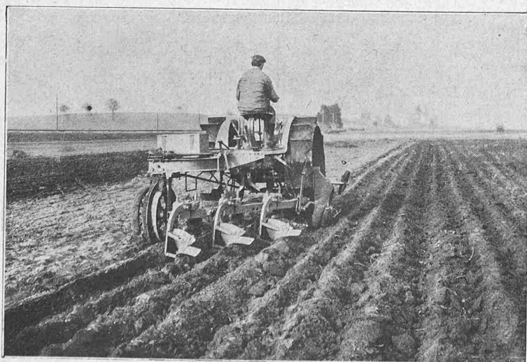
Abb. 2. Der Motorpflug „Winterthur“ in Hinteransicht.
