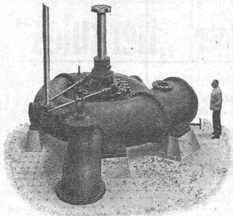
Turbine spirale de 6000 HP sous 105 m de chute pour l'Usine de la Jogne des Entreprises Electriques Fribourgeoises.
