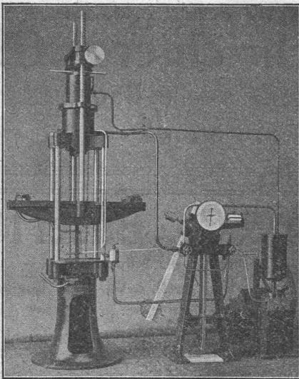
30 tons Zerreißmaschine
