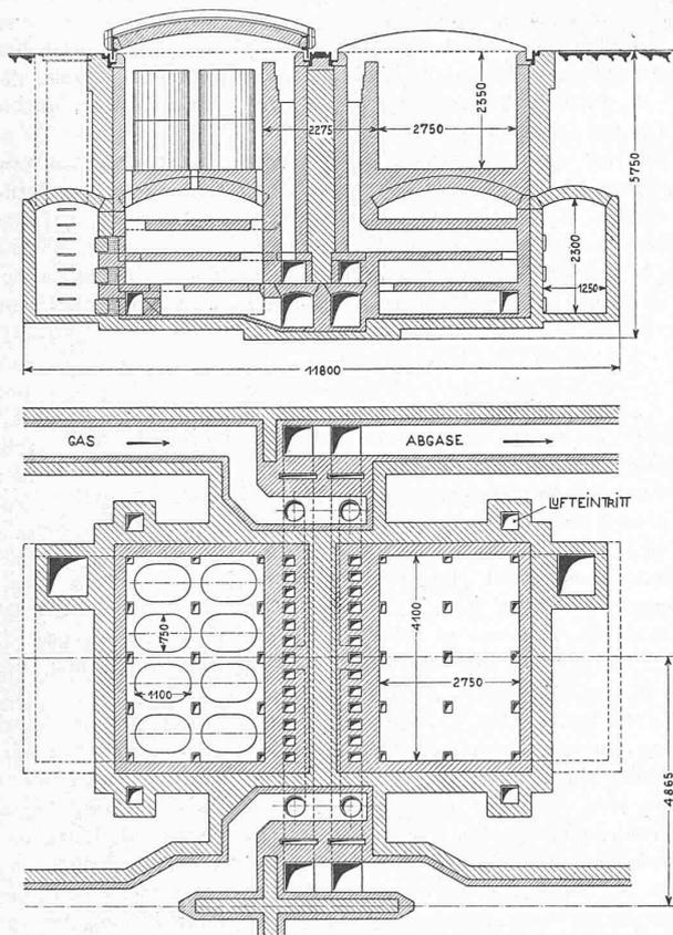
Abb. 7. Doppel-Temperofen mit Gasfeuerung und Rekuperatur. — 1:150.
