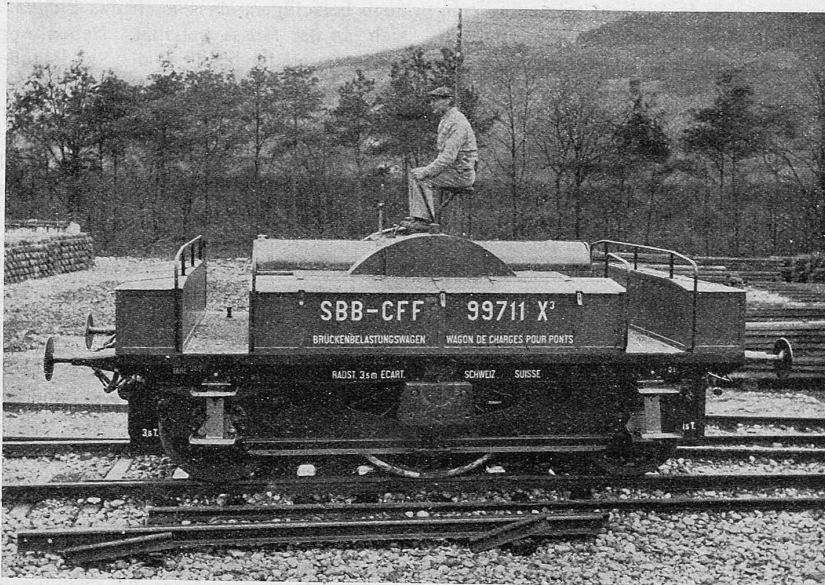
Abb. 2. Brückenbelastungswagen der Schweizerischen Bundesbahnen, fahrbereit.
