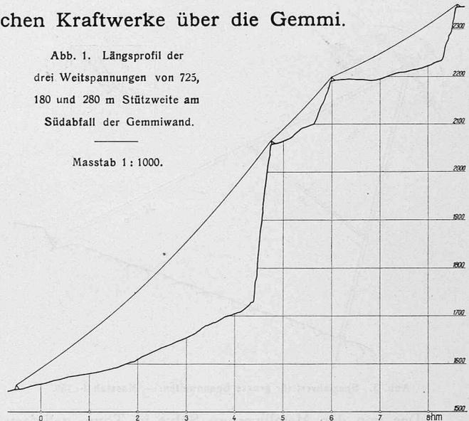
gestänge (40 m Stangenabstand und 10 m Minimal-Stangenhöhe). Bei den Winkelpunkten und grösseren Spannweiten (bis 200 m) wurden Gittermasten verwendet, während für die grossen Weitspannungen, die im folgenden noch näher besprochen werden sollen, Spezialkonstruktionen Verwendung fanden. An einzelnen günstigen Stellen sind für Spannweiten bis zu 100 m auch Böcke mit Holzmasten und Eisentraversen erstellt worden, um an Kosten zu sparen.
