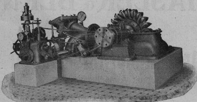
Pelton turbine für 1500 PS Leistung bei 419<sub>m</sub> Gefälle
