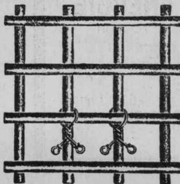
Verwendung beim binden von Betoneisen.
