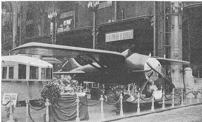
Abb. 4. Höhen-Kampfflugzeug in Holzbau der Firma Nieuport-Astra, mit 300 PS-Motor.
