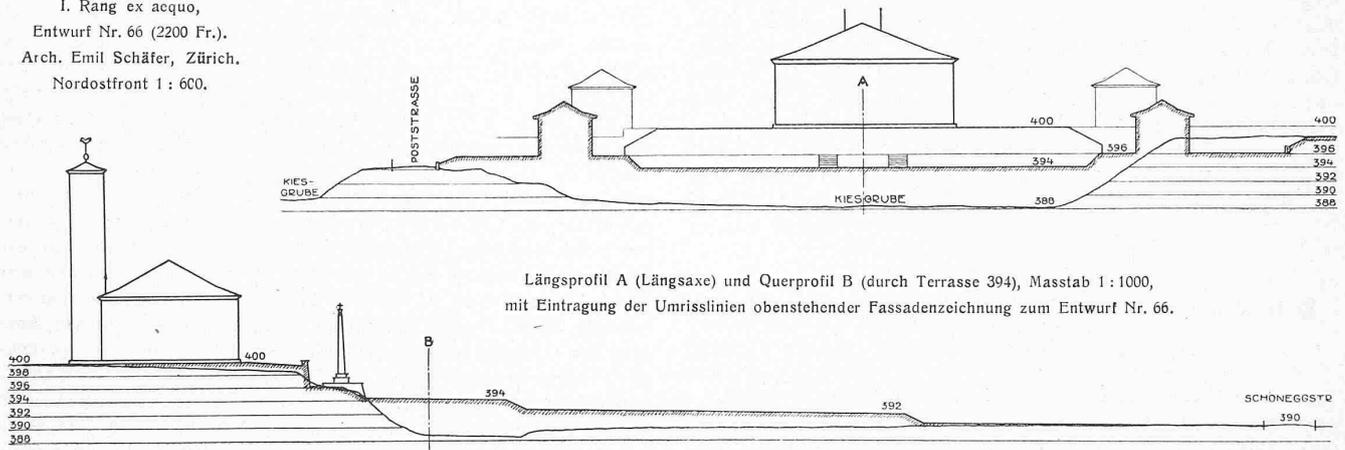
Längsprofil A (Längsaxe) und Querprofil B (durch Terrasse 394), Masstab 1 : 1000,
