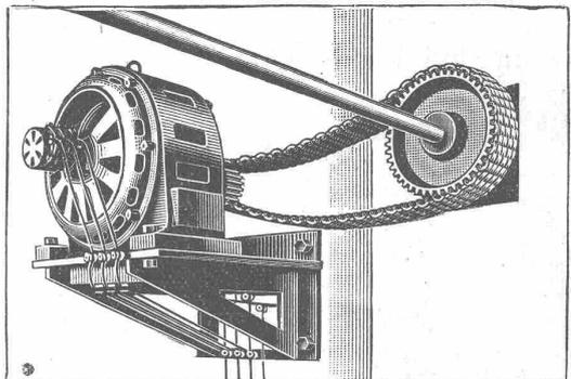
Positive Kraftübertragung bei kleinsten Wellenabständen, daher Platzersparnis.
