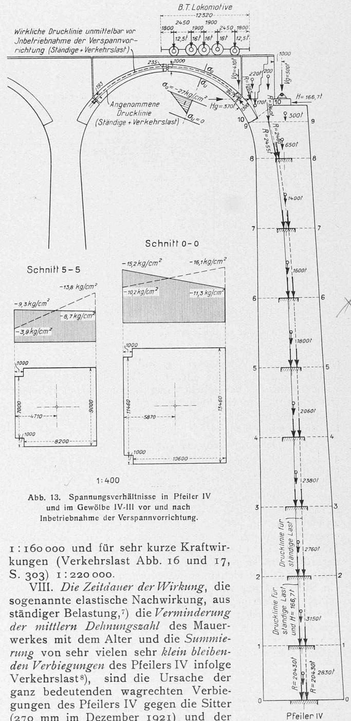
Abb. 13. Spannungsverhältnisse in Pfeiler IV und im Gewölbe IV-III vor und nach Inbetriebnahme der Verspannvorrichtung.
